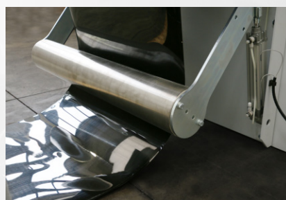
Neuentwickelter pneumatischer Tänzerarm gewährleistet die Verarbeitung aller Arten von Folien von der Vollfolie bis zum Stanzgitter mit anhaftenden Teilen.
