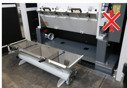
Bei Routine-Wartungsarbeiten sind die Hauptbauteile ohne Werkzeuge zugänglich. Wartung von einer Seite möglich.
