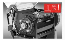
Mahlkammer mit 550HV gehärtet; Trichteröffnung mittels Gasdruckzylinder.
