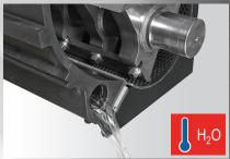
Wasserkühlung der Mahlkammer. Die Siebfläche entspricht ca. 50 % des Schneidkreises.
