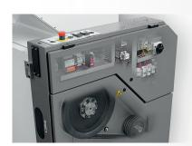
Integriertes Elektrobedienfeld. Sicherheitseinrichtungen und -schaltungen gemäß EU-Richtlinien.
